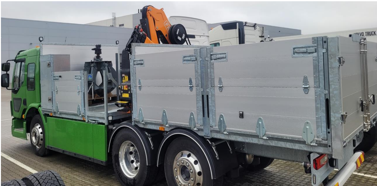
1 Storskralsbil med kran
