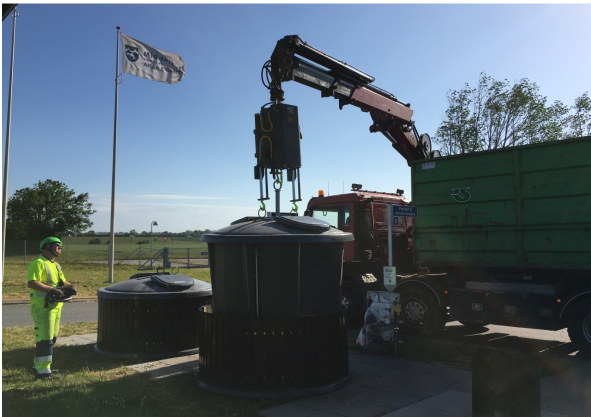
Billede 1: Affald & Genbrugs kranbil tømmer beholder med tre løfteøjer ("three loops in line") på Middelfart Genbrugsplads.
